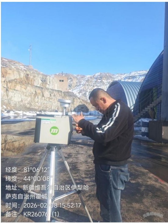
无组织废气现场采样
