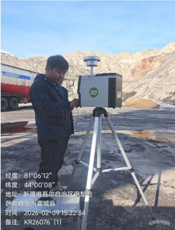
无组织废气现场采样
