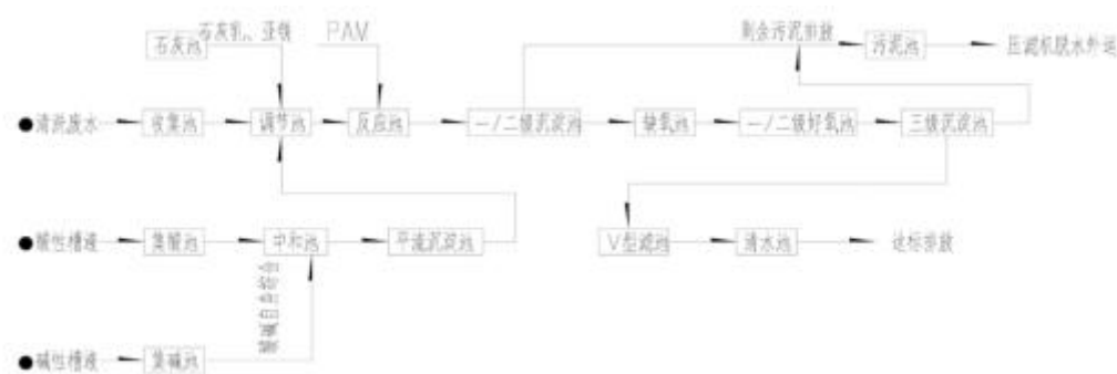
图 5 污水处理站工艺流程图
