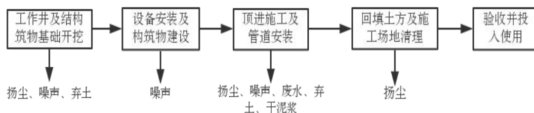
框图 4-1 施工工艺及产污环节图
